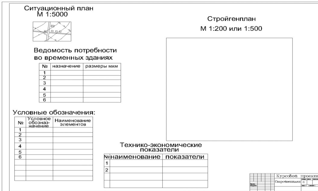
Рисунок 1. Схема компоновки графического листа
