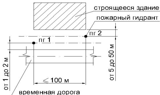
**Рисунок 4. Требования к размещению пожарных гидрантов**
