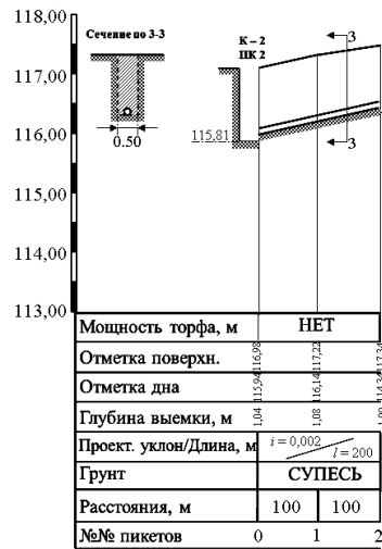
Рис. 1.44. Продольный профиль дрена
