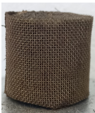
Рис. 1. Контейнер К-30 с торфяной почвой Fig. 1. Container K-30 with peat soil
