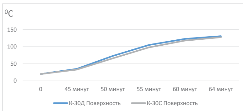
Рис. 7. Динамика разогрева поверхностей образцов К-30Д и К-30С до самовоспламенения торфяной почвы, обработанной дизельным топливом, при объемной плотности 1,1 \text{ г/см}^3
