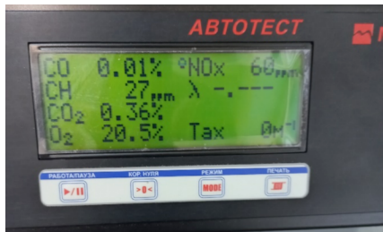
Рис. 6. Показания газоанализатора при возникновении тления образца торфа
