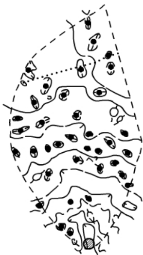
Рис. 2. Схемы размещения колодцев-поглотителей с цеолитовыми фильтрами на водосборных площадях
