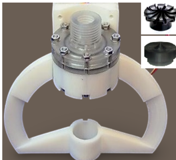
Рис. 4. Спринклер, сменные дефлекторы Fig. 4. Sprinkler, replaceable deflectors
