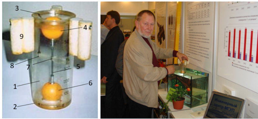
Рис. 3. Действующая модель устройства для очистки водной поверхности водных объектов от нефтепродуктов и плавающего мелкого мусора:
