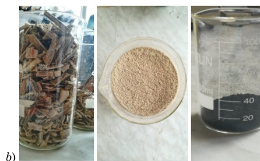
Рис. 5. Алгоритм получения из зеленой массы борщевика Сосновского биопродуктов: a – алгоритм; b – гранулы, порошок, топливо
