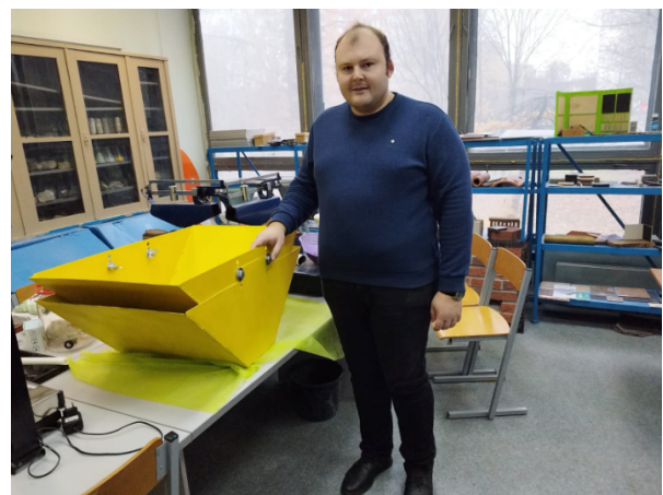
Рис. 3. Стенд для формирования и исследования моделей бетонных лотков мелиоративных каналов:
