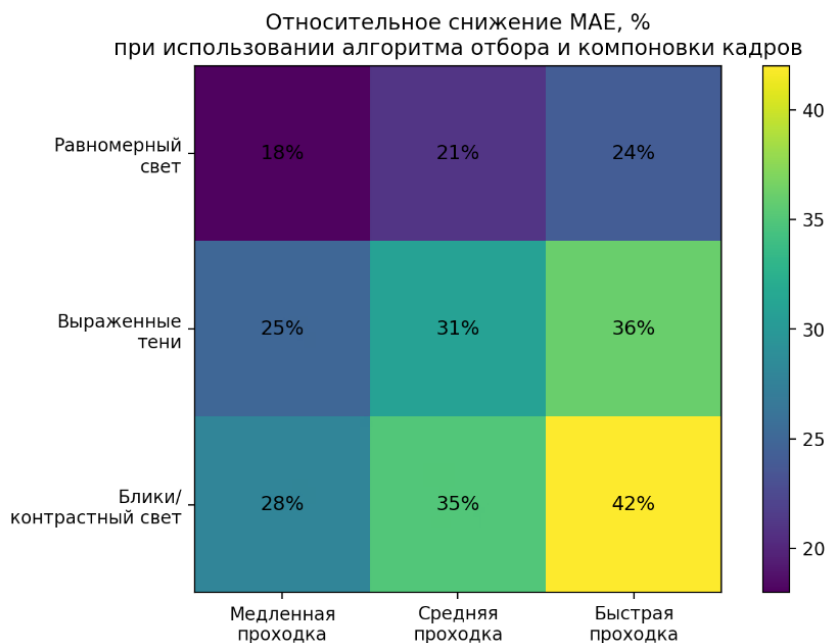
Рис. 7. Тепловая карта относительного снижения MAE при использовании алгоритма в зависимости от условий освещения и скорости прохода животного
