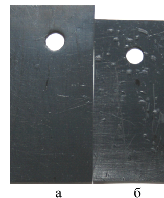
Рис. 5.5. Фото образцов резины марки НО68-2 после 288 ч контакта: а – с МЭРМ; б – с ДТ
