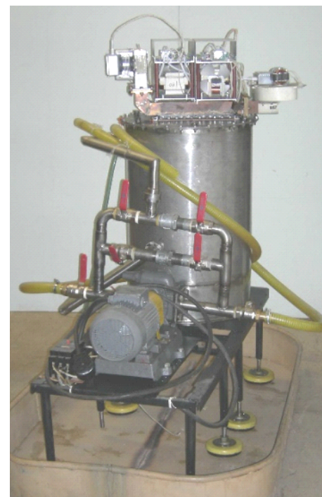
Рис. 6.9. Общий вид установки для СВЧ-обработки компонентов смесового биотоплива при его изготовлении
