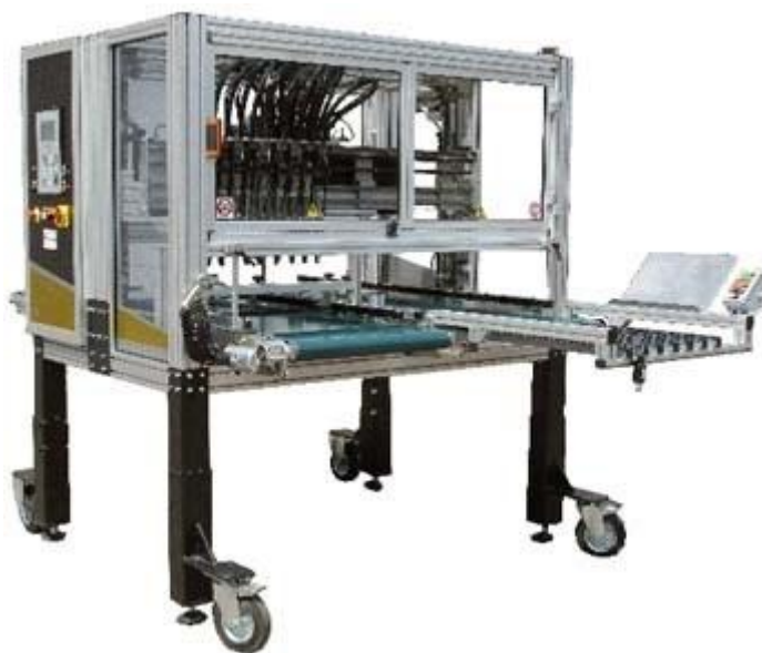
Рис. 37. Машина CUBE XT 600 N для пересадки укорененных черенков из кассет в контейнера различного объема
