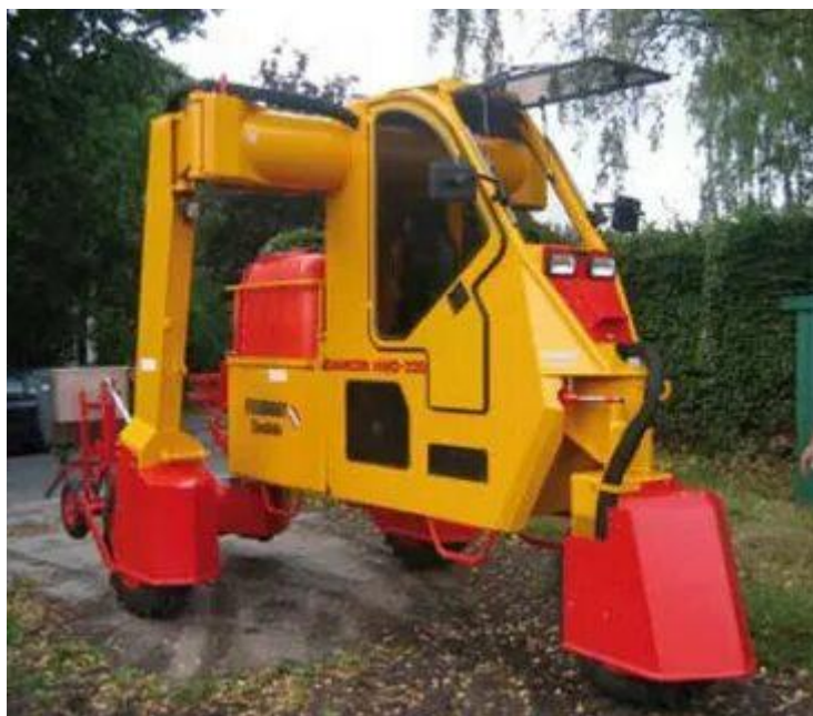
Рис. 36.Высококлиренсная машина Damcon Multitrike 355
