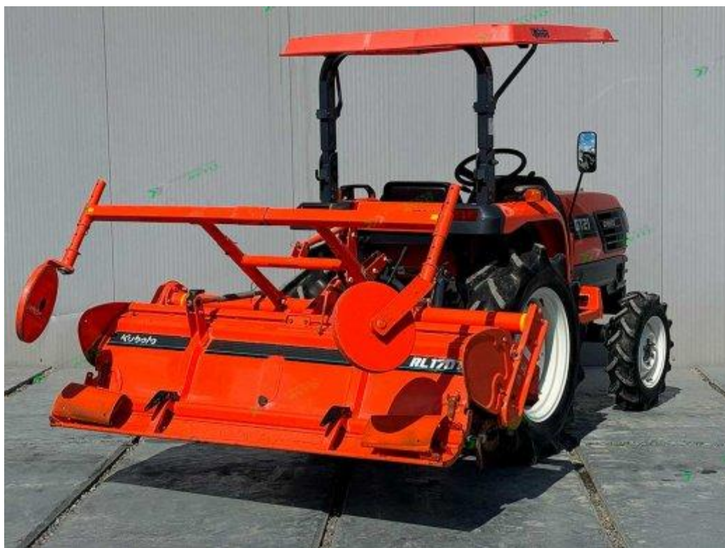
Рис. 35. Минитрактор Kubota GT 21 с ПСМ JP – 1225/24 и фрезой RL 170 T (рабочая ширина захвата 170 см)
