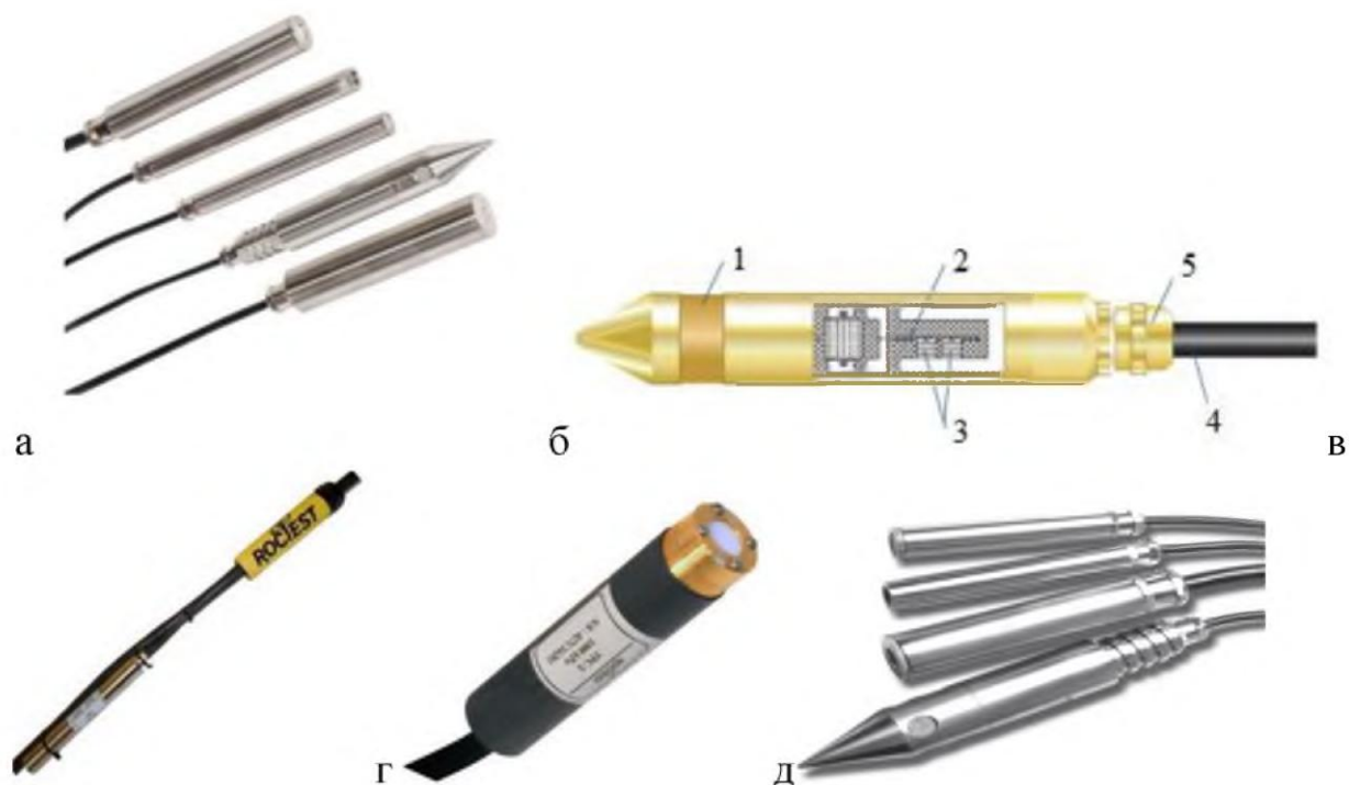
Рис. 5.40. Традиционные датчики для пьезометров: а – струнного типа PW; б – струнный типа CL1; 1- бронзовый или керамический фильтр; 2 - вибрирующая струна; 3 -
