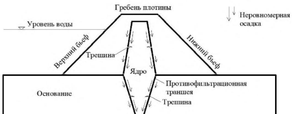
Рис. 3.12. Схема формирования зон низкого напряжения и трещин в плотине с ядром
