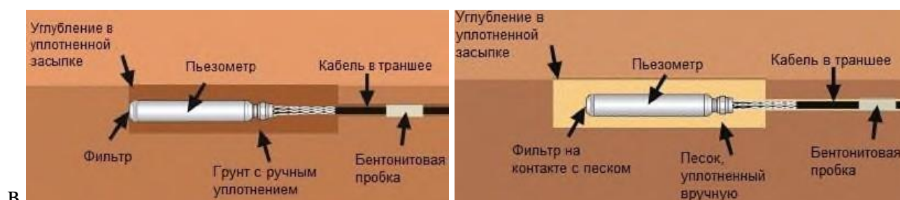
Рис. 5.30. Наблюдения за уровнем подземных вод: а – оценка УГВ в безнапорном пьезометре (поверхностный шахтный пьезометр); б – контроль напора в изолированном водоносном горизонте (глубинный пьезометр); в – точечная установка пьезометра
