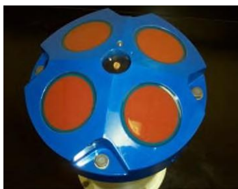
Рис. 2.37. Акустический доплеровский измеритель течения (ADCP)
