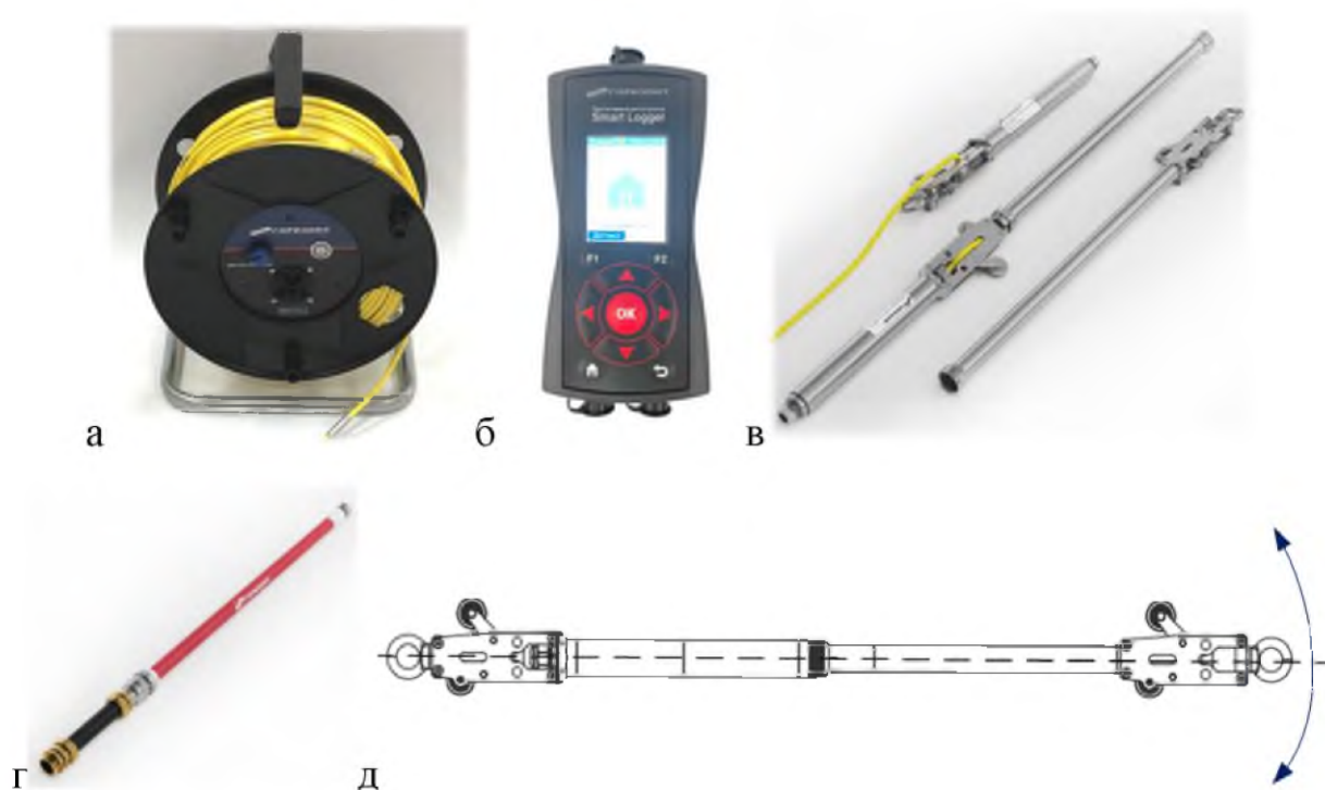
Рис. 5.20. Состав двухосевых инклинометров разных модификаций, стационарного и портативного применения, устанавливаемых в обсадные трубы или непосредственно в грунт (ООО «НПТ Горизонт»): а – катушка; б – внешний вид портативного регистратора; в – инклинометр BIN-D3-XX-10-WW-V, BIN-D3-XX-10-WW-H; г – BIN-D3-XX-00-WW-V; д – направление измерительных осей инклинометра BIN-D3-50-20-WW-H
