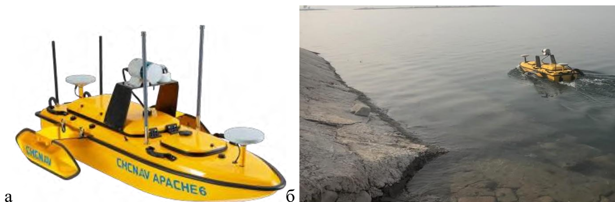
Рис. 2.33. Беспилотный дрон АРАСНЕ6 для замеров на внутренних водоёмах и мелководье
