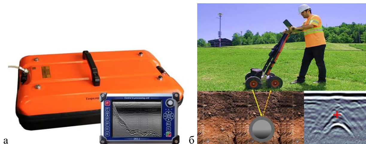
Рис. 5.48. Общий вид георадара (а) и работы комплекта для георадиолокационного диагностирования (б)
