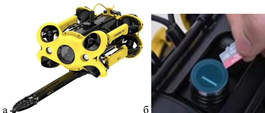
Рис. 2.31. Дрон Chasing M2: а – общий вид; б – цифровая камера со съёмной картой памяти на 512 ГБ
