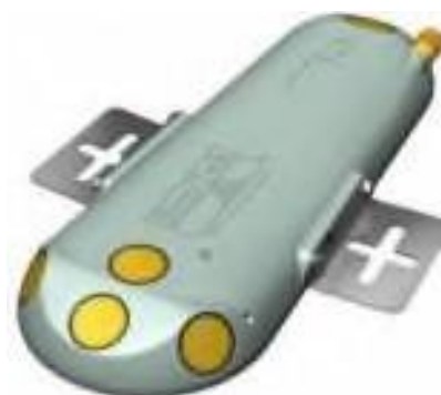
Рис. 2.38. Профилографы: а – многочастотный RiverSurveyor M9 с программным комплексом НУРАК; б - акустический пятилучевой SonTek IQ
