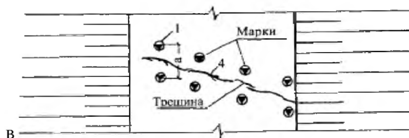
Рис. 2.14. Схема размещения временных высотных марок для контроля просадки(а), оползня (б) и трещины (в): 1 – поверхностная марка; 2 – воронка проседания; 3 – массив оползня; 4 - трещина
