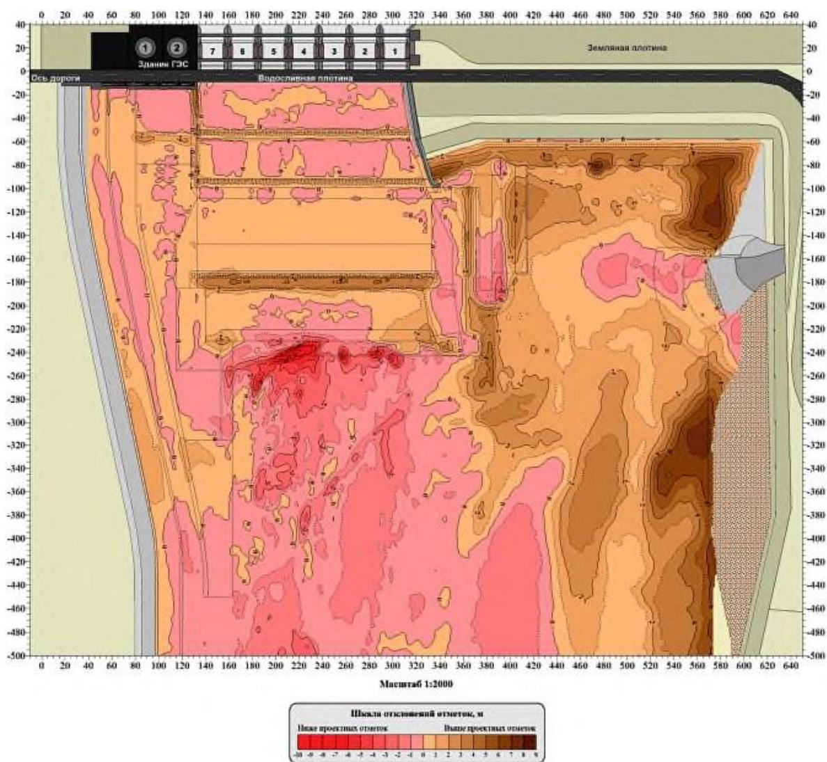
Рис. 2.21. Карта рельефа и отклонений отметок дна от проектных отметок
