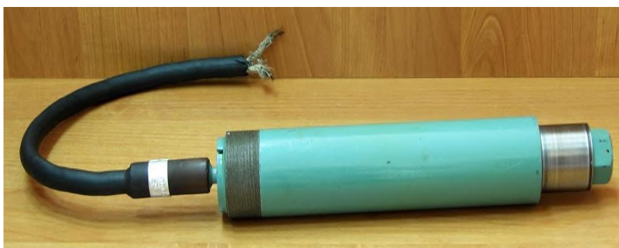
Рис. 5.46. Общий вид преобразователя линейных перемещений струнного типа ПЛПС-320(160)
