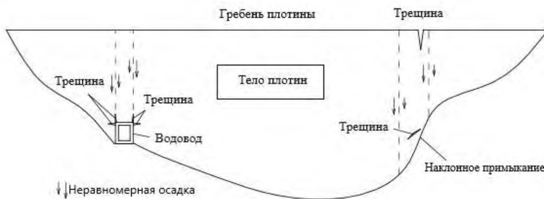
Рис. 3.10. Формирование зон низкого напряжения и трещин вблизи водовода и устоя в теле грунтовой плотины
