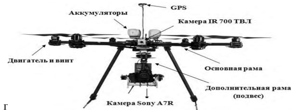
Рис. 2.26. Общий вид (а-в) и основные элементы (г) БПЛА
