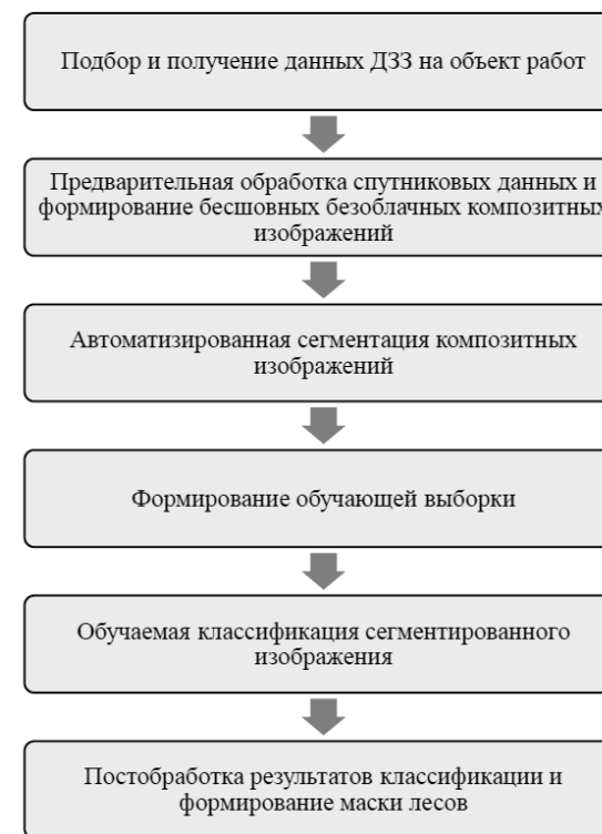
Рис. 4.1. Общая схема проведения классификации материалов ДЗЗ с целью оконтуривания границ класса лесной площади
