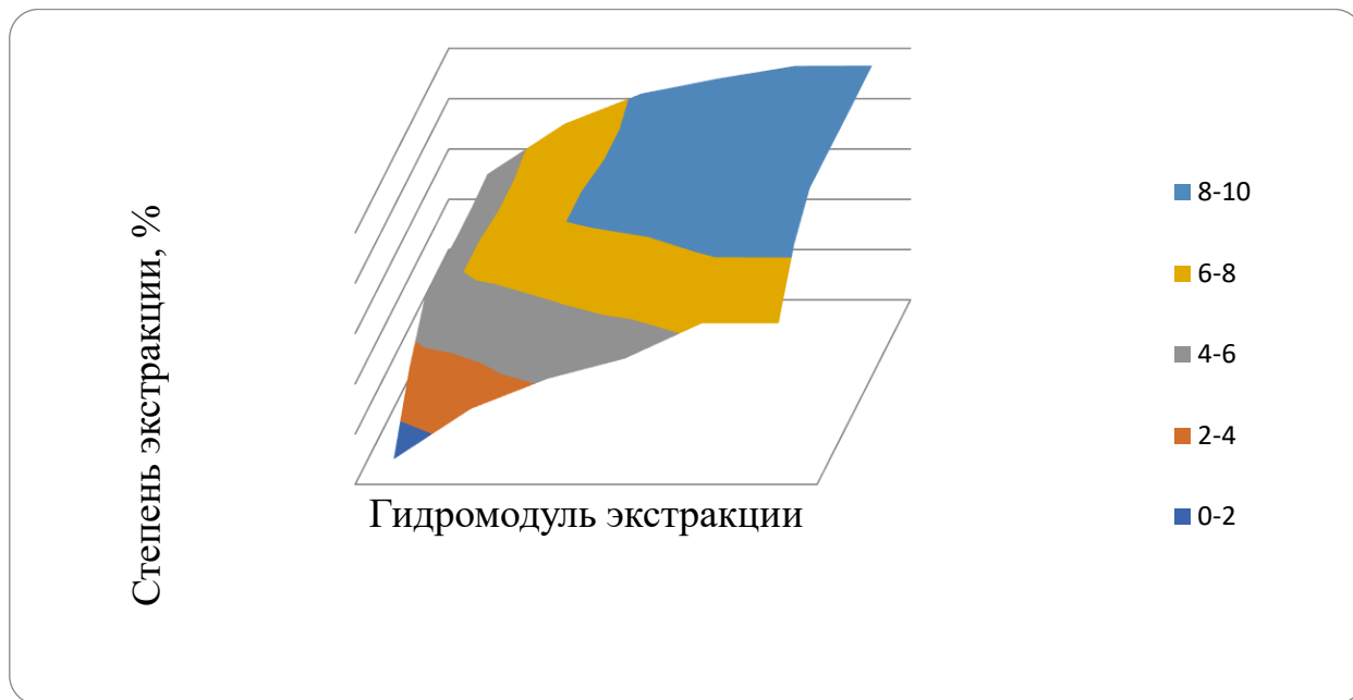
Рисунок 14. Зависимость степени экстракции водой белка из клубней топинамбура от гидромодуля и продолжительности экстракции при температуре 1 °С
