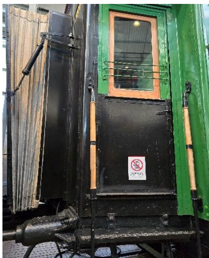
Гармошка- переход из брезента между вагонами. Музей железнодорожного транспорта, С-Петербург
