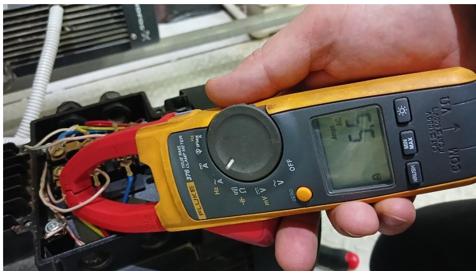
Рисунок 2 – Измерение рабочего тока электродвигателя
