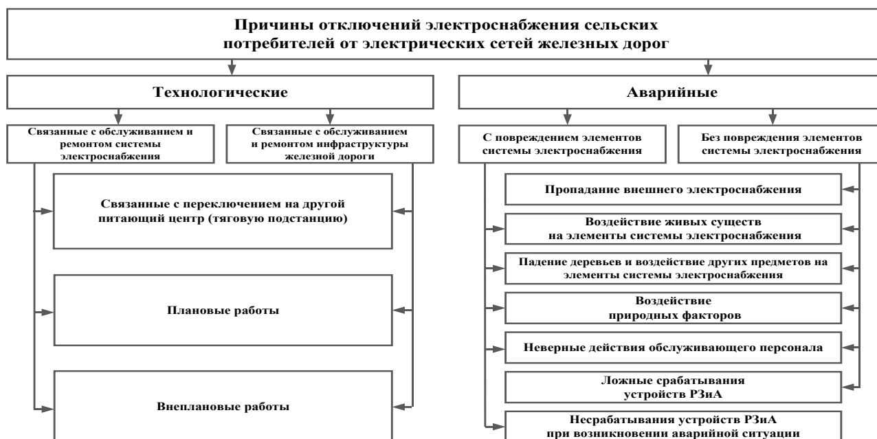
Рисунок 3 – Классификация причин отключений электроснабжения сельских потребителей от электрических сетей железных дорог
