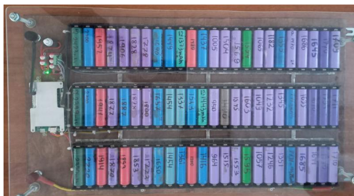
Рисунок 1 – Аккумуляторная батарея 3S24P со сменными аккумуляторами
