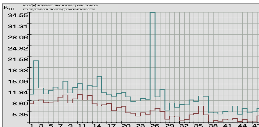
Рисунок 1 – Суточный график изменения коэффициента несимметрии напряжений по нулевой последовательности
