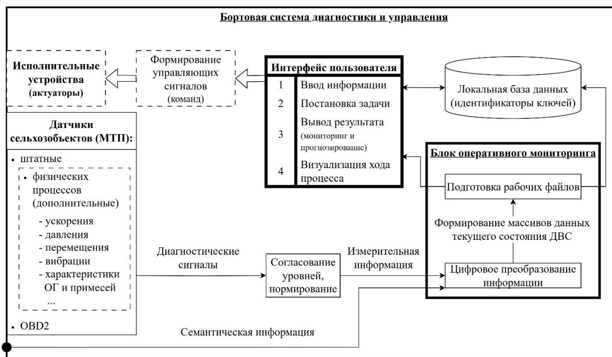
Рисунок 2 – Схема получения и преобразования диагностических сигналов ДВС
