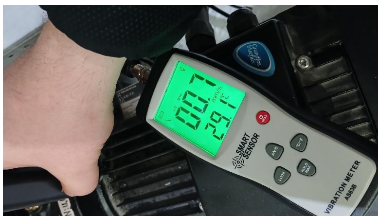
Рисунок 4 – Анализ вибрации подшипникового узла электродвигателя
