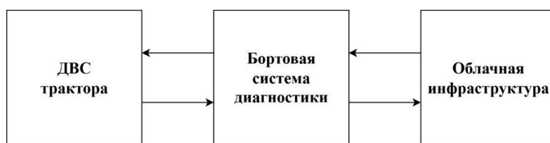
Рисунок 1 – Общая схема взаимодействия информационных потоков
