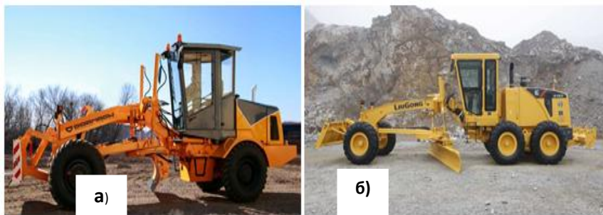
Рис. 11.6 Автогрейдеры по ходовому оборудованию: а-двухосные; б-трехосные.
