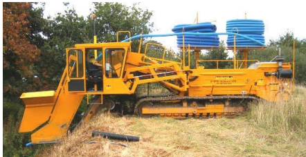
Рис. 21.19. Цепной скребковый экскаватор-дреноукладчик с бункером для обсыпания дренажной трубы и перемещающейся кабиной
