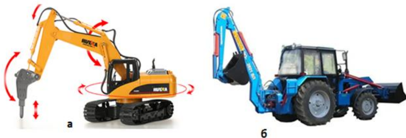
Рис.9.3 Одноковшовые экскаваторы: а- полноповоротный; б- неполноповоротный.
