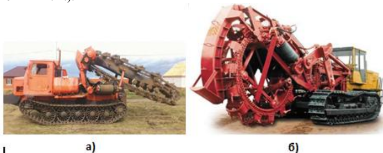
Рис. 10.2 Экскаваторы продольного копания: а-цепные; б-роторные Выпускается три типа многоковшовых экскаваторов (траншеекопатели):
