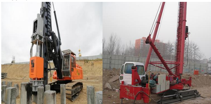
Рис.17.13. Копровая установка: а- на базе экскаватора;б- на рельсовом ходу.
