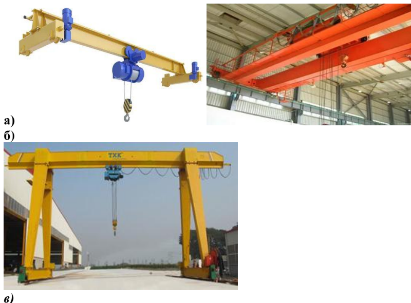
Рис.8.20 Схема устройства пролетных кранов: а) кран-балка; б) мостовой кран; в) козловой кран.
