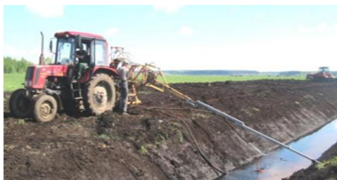
Рис.23.5. Установка для промывки дренажа УПД-120
