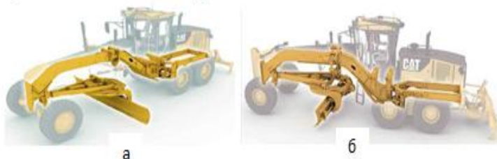
Рис. 11.5 Исполнения рам автогрейдеров : а-цельная рама; б-шарнирная рама.
