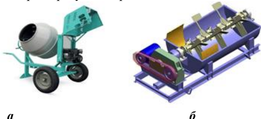
Рис.19.2 Смеситель циклического действия: а) гравитационный; б) с принудительным перемешиванием.
