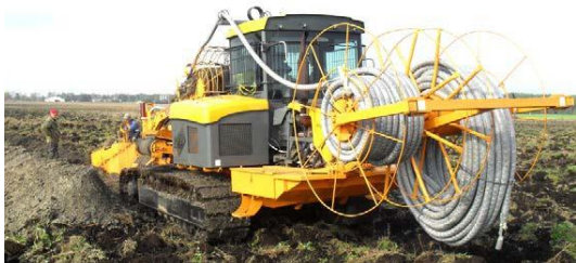
Рис. 21.18. Экскаватор-дреноукладчик ЭТЦ-203 в работе
