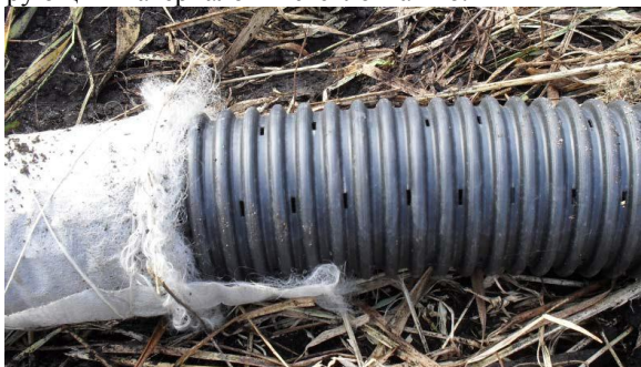
Рис. 21.6. Гофрированная пластмассовая труба с фильтрующим защитным материалом
