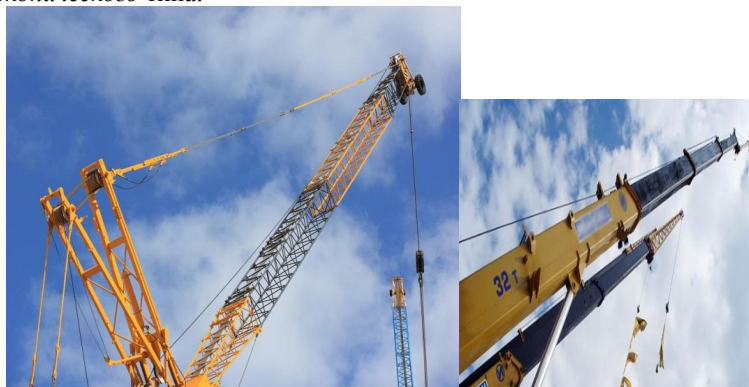
Рис.8.13 Пневмоколесные краны: а) решётчато-составные; б) телескопические-цельнометаллические
