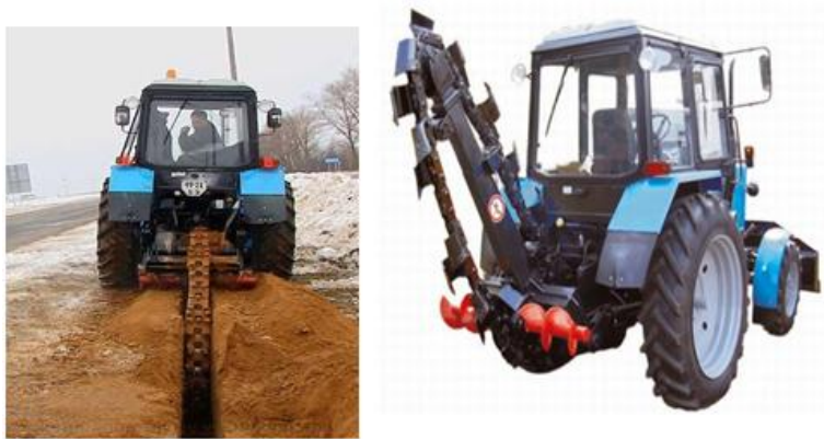
Рис. 10.3 Цепной экскаватор с рабочим оборудованием скребкового типа.
