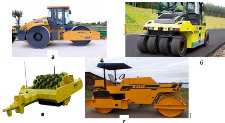
Рис.15.2.Типы статических уплотняющих машин: а-трехвальцовый каток; б- пневматический каток; в- прицепной кулачковый каток; г- двухвальцовый каток.
