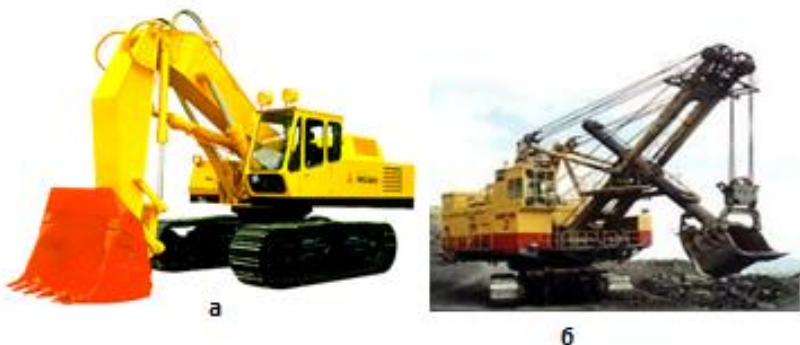
Рис.9.6 Общий вид экскаваторов прямая лопата: а-гидравлический; б-механический.
