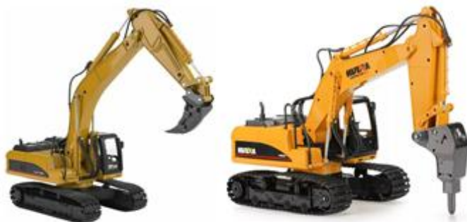
Рис. 9.11 Экскаватор с рабочим оборудованием: а-однозубый рыхлитель; б-гидромолот.
