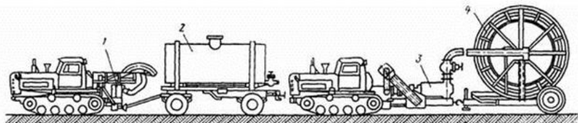
Рис.23.7. Машина для промывки дрен ПДТ-125: 1 - насосная станция с насосом С-245; 2 - цистерна на прицепе 2ПТС-4-793; 3 - насосная станция ЗМС-10У34у 184; 4 - тележка с барабаном.
