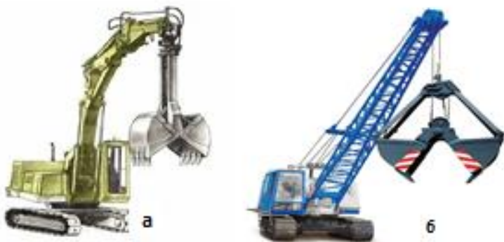
Рис. 9.8 Экскаватор с рабочим оборудованием грейфер: а-гидравлический; б-механический.
