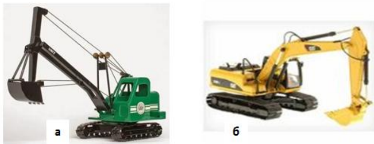
Рис.9.4 Одноковшовые экскаваторы по виду установки рабочего: а- с гибкой подвеской рабочего оборудования; б- с жесткой подвеской рабочего оборудования.
