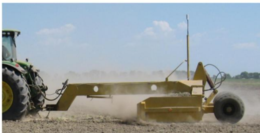
Рис.24.5. Короткобазовый планировщик ПАУ-4,2 с лазерным управлением.
