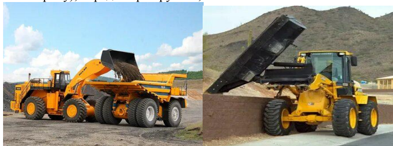
Рис.8.30 Ковшовые погрузчики: а) с разгрузкой вперед; б) с боковой разгрузкой.
