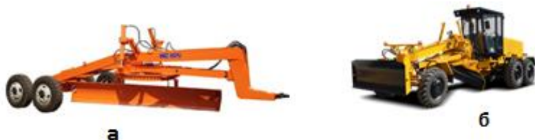
Рис. 11.3 Грейдеры: а-прицепной; б-самоходный (автогрейдер).
