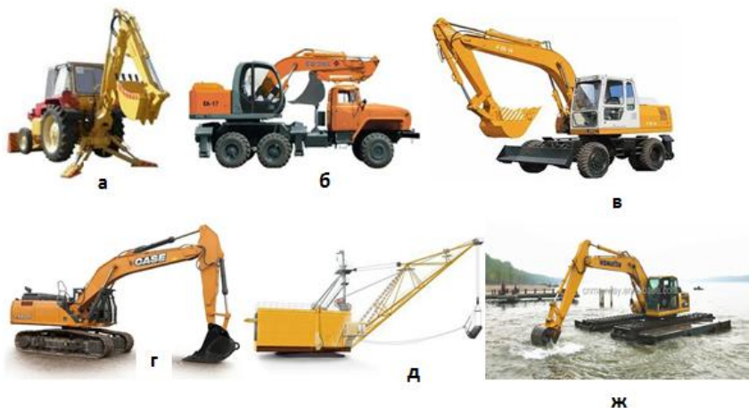
Рис.9.2 Одноковшовые экскаваторы на различных по типу шасси.
