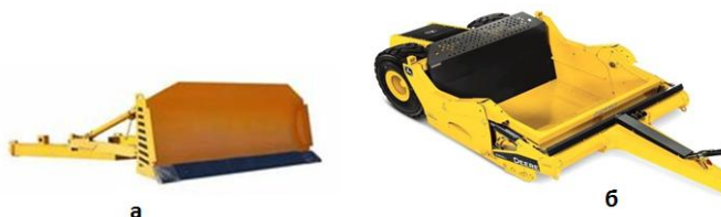
Рис. 11.1 Рабочие органы землеройно-транспортных машин: а-отвал с режущим ножом; б-ковш скрепера.
