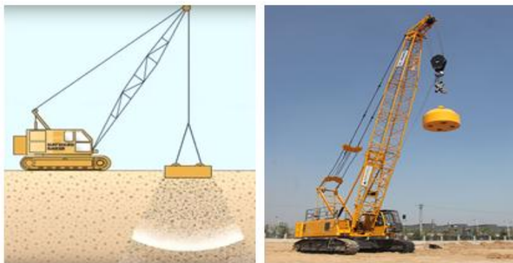
Рис. 15.4. Схема оборудования для уплотнения грунтов тяжелыми трамбовками
