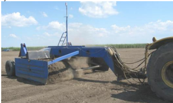
Рис.24.6. Короткобазовый скрепер-планировщик СП-4,2 с лазерным управлением.
