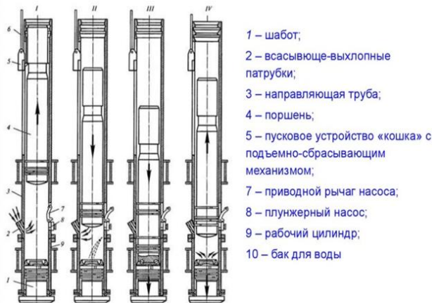
Рис. 17.5. Последовательность работы трубчатого дизель-молота
