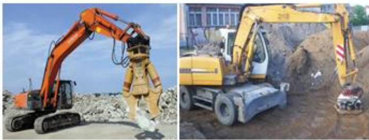
Рис.9.12 Экскаватор с рабочимоборудованием: а-гидроножицы; б-вибротрамбовщик.
