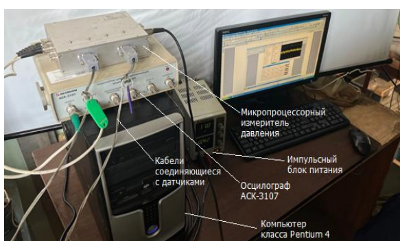
Рисунок 2.6 – Измерительное оборудование в комплекте для определения пульсационных характеристик потока
