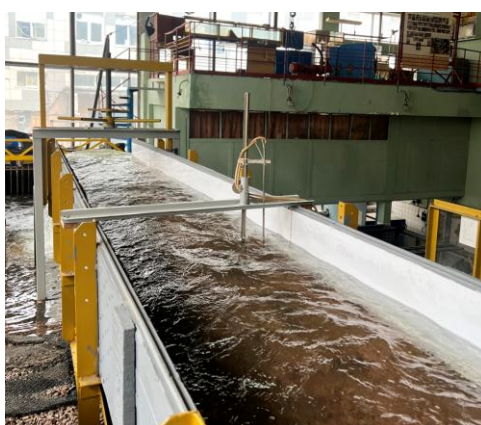
Рисунок 2.4 – Картина движения потока на модели, где происходит измерение скоростей потока трубкой Пито
