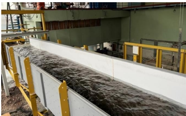
Рисунок 3.1 – Вертикальная стенка лотка, покрытая глянцевыми пластмассовыми листами
