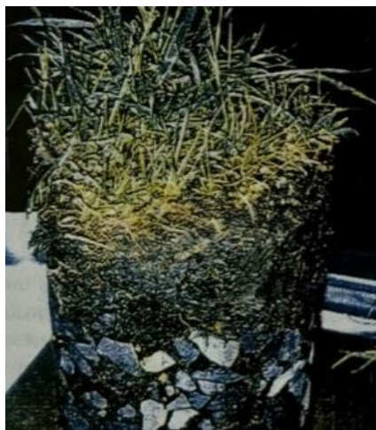
Рисунок 1.17 – Укрепление с травянистыми растениями: керн защитного крепления из известкового щебня и мастики [59]
