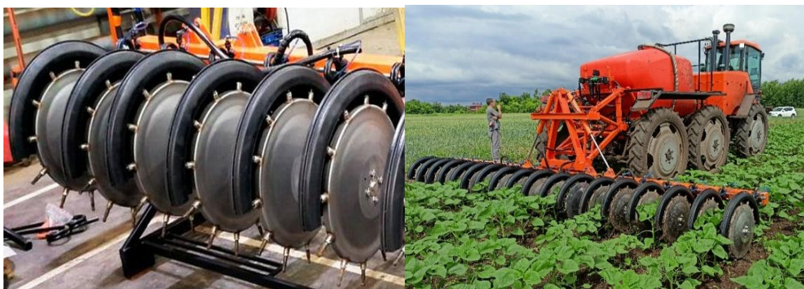
Рисунок 2. Подкормка подсолнечника КАС мульти-инжектором «Туман-3» с защитными щитками.
