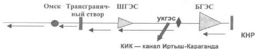
Рис. 4.2. Укрупненная схема многоотраслевого каскадного трансграничного водохозяйственного комплекса
