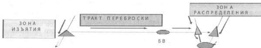
Рис. 5.14. Принципиальная схема межбассейновой переброски стока
