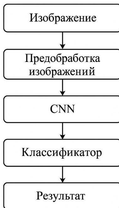
Рисунок 2 – Блок-схема работы системы прогнозирования
