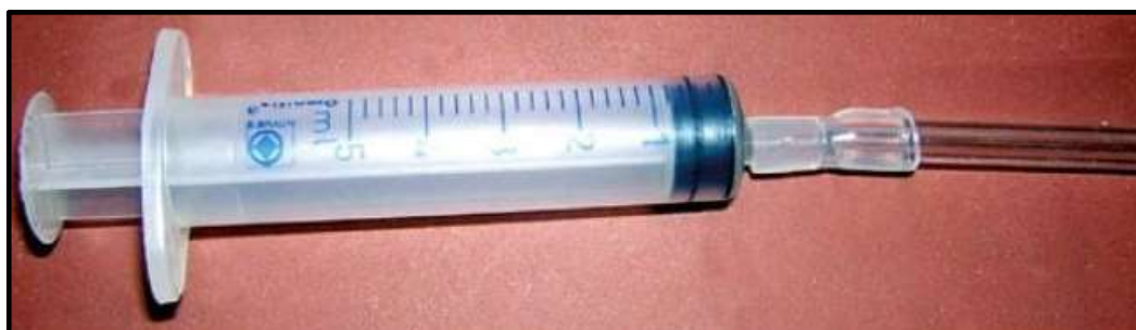
Рисунок 37 –Соединение полистироловой пипетки со шприцом
