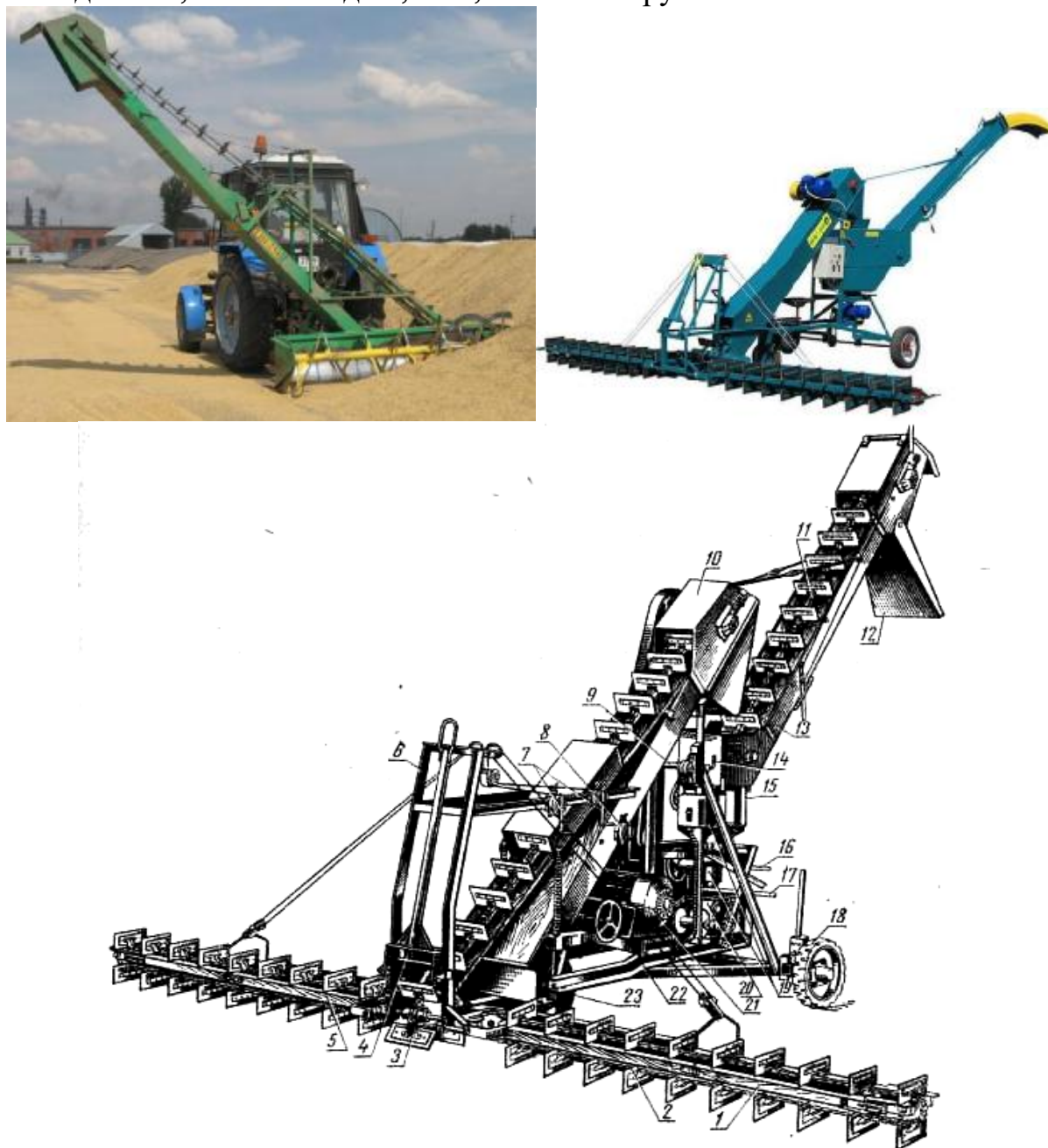
Рис. 6.13. Погрузчик непрерывного действия зерновой: 1 - левый питатель; 2 - скребковая цепь питателя; 3 - скребковая цепь промежуточного транспортера; 4 - дышло; 5 - правый питатель; 6 - рама питателей; 7 - лебедка подъема питателя; 8 - механизм подъема; 9 - контрпривод; 10 - промежуточный транспортер; 11 - скребковая цепь отгрузочного транспортера; 12 - лоток; 13 - отгрузочный транспортер; 14 - рукоятка рычага выключения муфты контрпривода; 15 - поворотная колонка; 16 - фиксатор поворотной колонки; 17 - рычаг включения муфты редуктора; 18 - заднее колесо; 19 - привод отгрузочного транспортера; 20 - самоход; 21 - электродвигатель; 22 - рама машины; 23 - переднее колесо.
