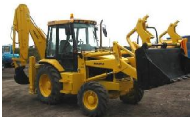
Рис. 6.4. Погрузчики периодического действия: а – фронтальный с передней навеской; б – фронтальный с передней и задней навеской; в – фронтально-перекидной
