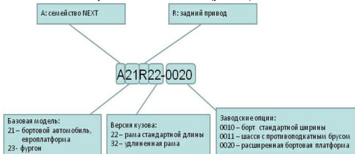
Рис. 3.3. Расшифровка маркировки автомобиля A21R22 «Газель-Next»
