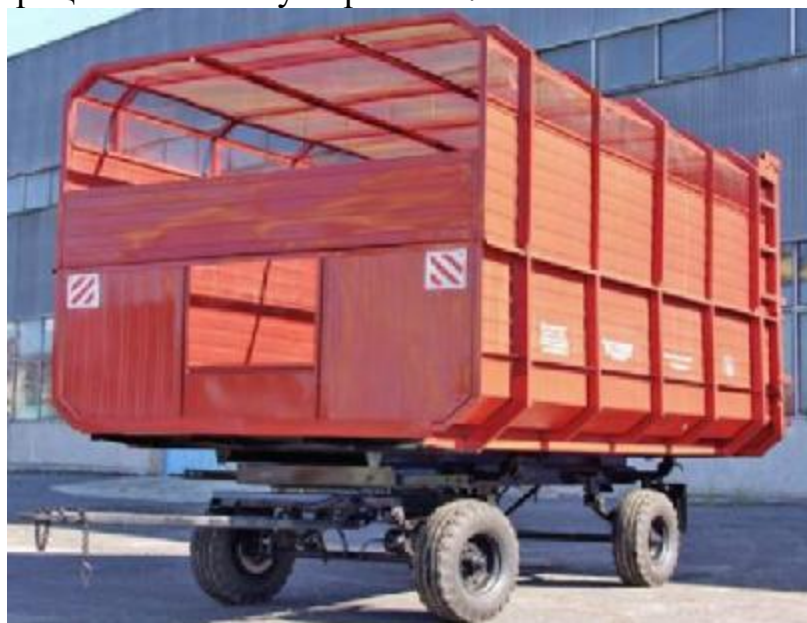
Рис. 2.4. Прицеп 2-ПТС-4-8549 со сменным кузовом вместимостью 45 м 3
