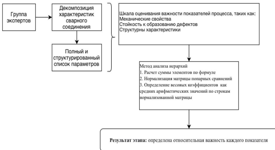
Рисунок 1 – Графическая интерпретация первого и второго этапов методики оценки качества сварных швов
