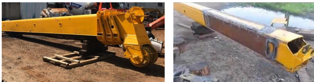
Рисунок 1 – Площадки размещения стрелы крана для ремонта
