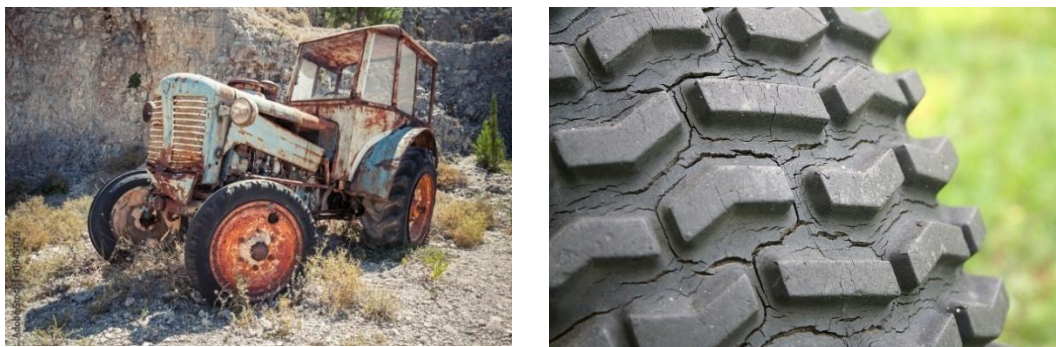
Рисунок 1 – Коррозия металла и износ полимерного материала
