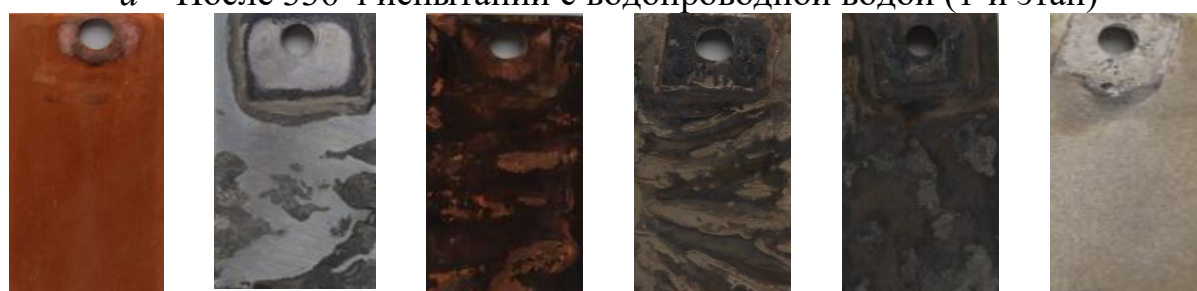
б – После 336 ч испытаний с охлаждающей жидкостью VN-RU-30 (2-й этап)
