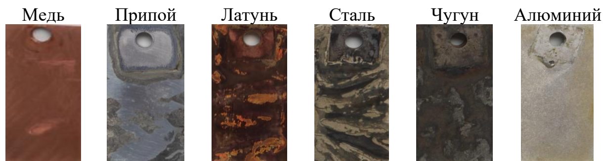
а – После 336 ч испытаний с водопроводной водой (1-й этап)
