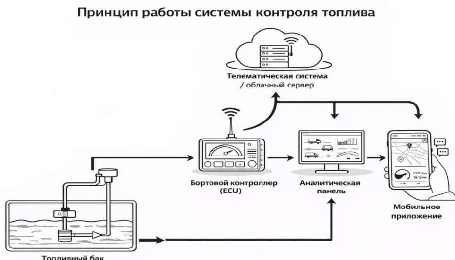
Рисунок 2 – Принцип работы системы контроля топлива
