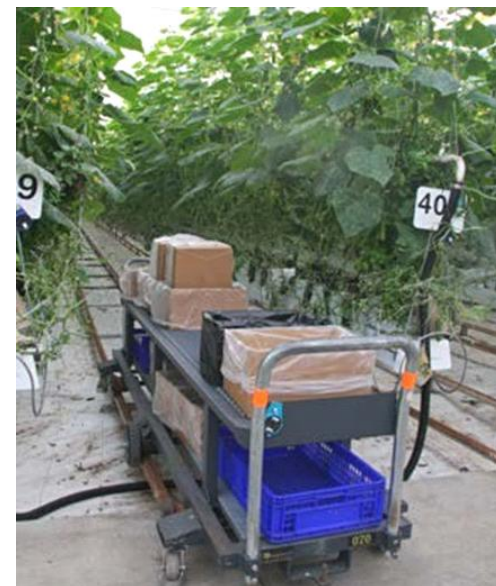
Рис. 10. Использование уборочных тележек, перемещающихся по направляющим систем отопления
