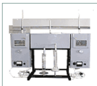
Рис. 10. Аппарат для определения фракционного состава АРНП-2
