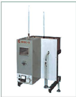
Рис. 8. Аппарат для определения фракционного состава АРНС-1э
