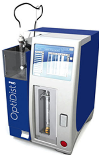
Рис. 16. Автоматический анализатор фракционного состава нефти и нефтепродуктов при атмосферном давлении (атмосферная разгонка) HerzogOptiDist
