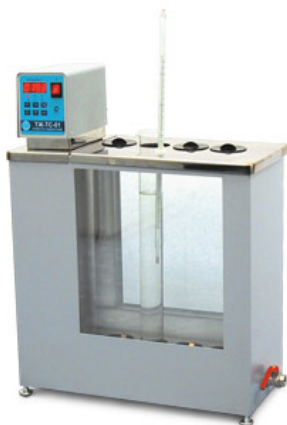
Рис. 36. Термостат для определения плотности
