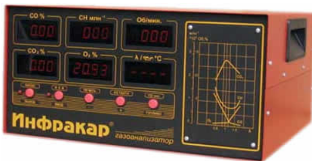
Рис. 5. Четырехканальный газоанализатор Инфракар М
