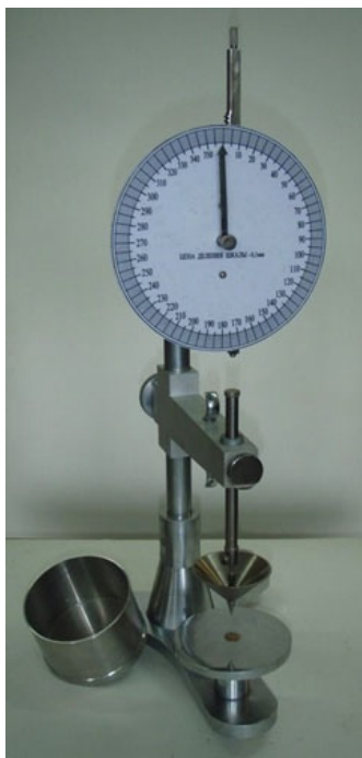
Рис. 34. Пенетрометр ПН-1ЖВ: 1 – конус; 2 – пусковая кнопка; 3 – кремальера; 4 – индикатор; 5 – стрелка.
