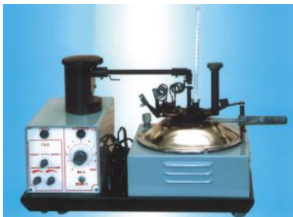
Рис. 24. Аппарат ТВЗ для определения температуры вспышки в закрытом тигле
