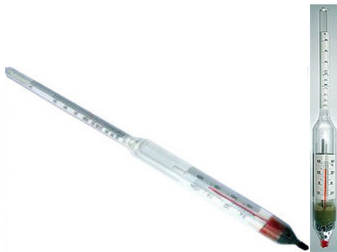
Рис. 40. Ареометр-гидрометр с термометром АЭГ
