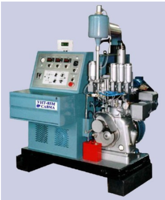
3722-002 Установка для испытания топлив УИТ-85М
