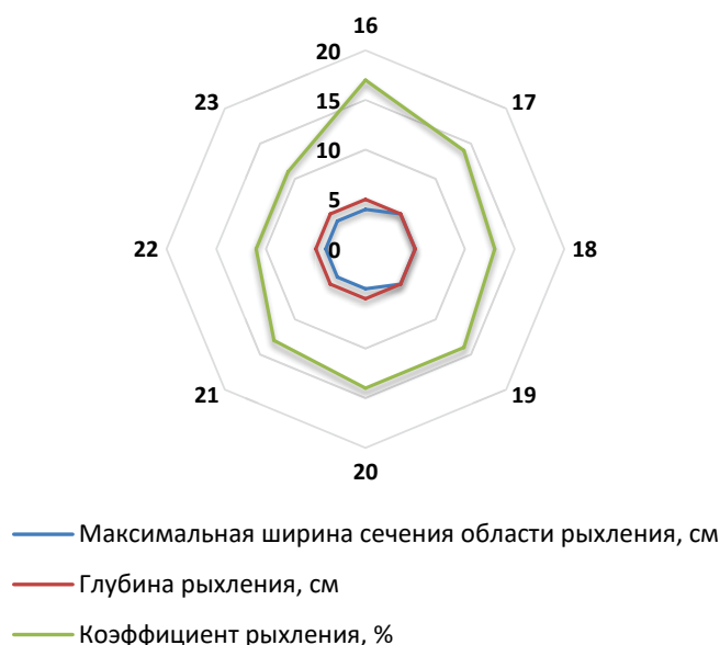
Рис. 5. Показатели качества воздействия воздушного потока на почву абсолютной влажности 16...23% при давлении сброса ресивера 0,5 МПа
