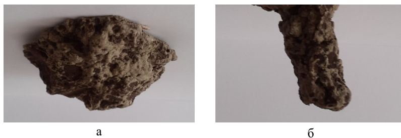
Рис. 4. Слпки области деформации при воздействии на почву сжатого воздуха в режиме ультразвуковых колебаний (а) и без него (б)
