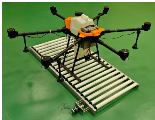
Рис. 6. Секция роликового конвейера для автономной сервисной платформы обслуживания сельскохозяйственных беспилотных летательных аппаратов
