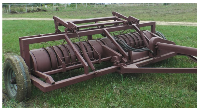
Рис. 2. Опытный образец инновационного двухпоточного вспушивателя ВЛ-2К
