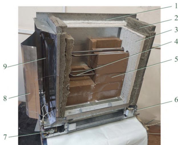
Рис. 2. Физическая модель комбинированного электрического теплоаккумуляционного обогревателя (КЭТО):
