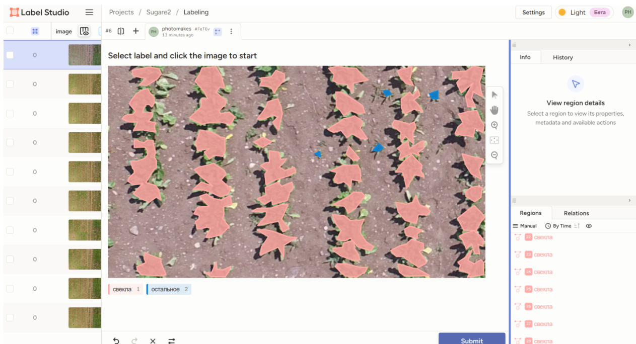
Рис. 3. Пример аннотирования аэрофотоснимка посевов сахарной свеклы в системе Label Studio: красный – класс «Свекла»; синий – класс «Остальное-сорняки»
