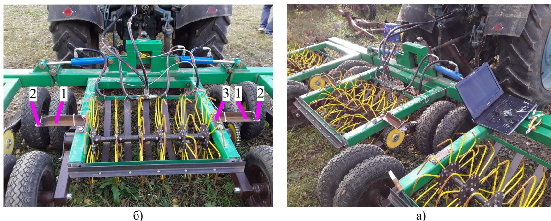
Рис. 4. Полевая установка вдушивателя для тензометрирования:
