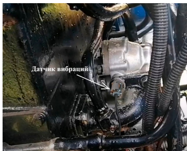
Рис. 1. Расположение датчика на корпусе насоса
