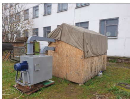
Рис. 2. Установка аэродинамического нагрева с макетом помещения:
