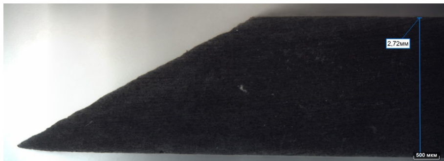
Рис. 6. Макроструктура ножей с углом заточки 30° после закалки и низкого отпуска, ×16 Fig. 6. Macrostructure of blades with a 30° sharpening angle after quenching and low tempering, ×16
