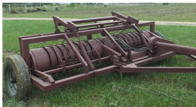
Рис. 2. Опытный образец инновационного двухпоточного вспушивателя ВЛ-2К
