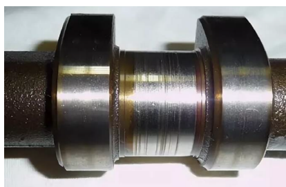
Рис. 1. Износ опорных шеек
