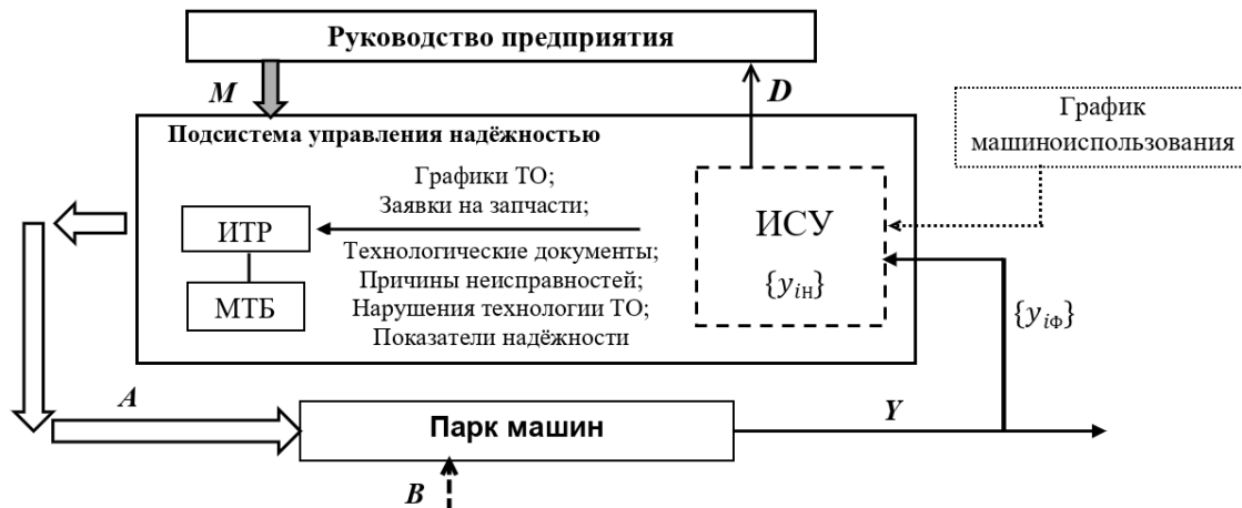
Рис. 3. Модель управления надежностью эксплуатируемых машин:
