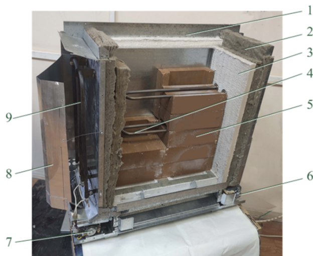
Рис. 2. Физическая модель комбинированного электрического теплоаккумуляционного обогревателя (КЭТО):
