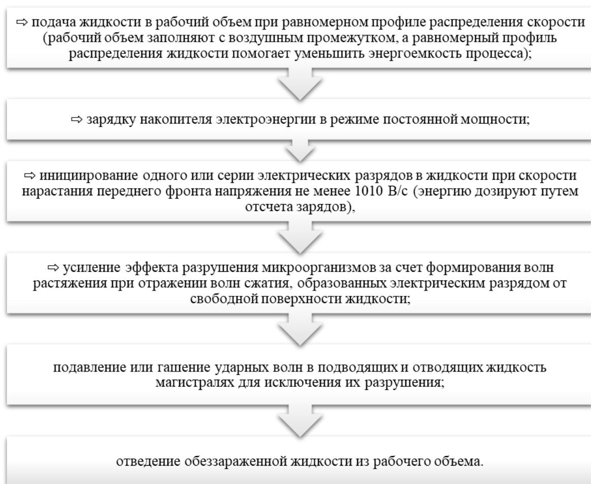
Рисунок 9.4 – Технологический процесс обеззараживания воды электроимпульсным способом
