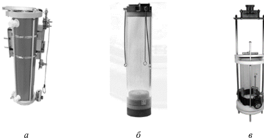
Рисунок 9.1 – Разновидности батометров: (а) батометр Нискина, (б) батометр Паталаса, (в) батометр Руттнера
