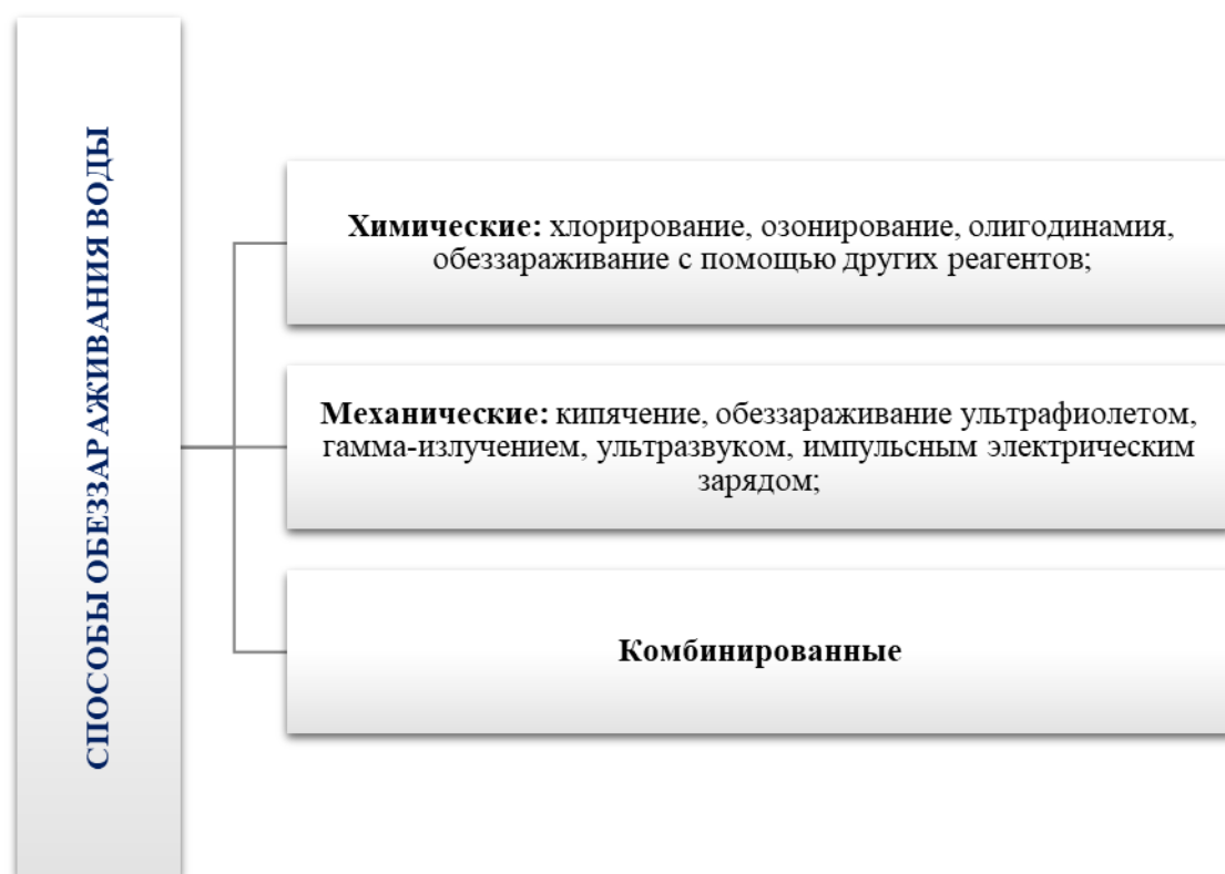
Рисунок 9.3 – Способы очистки и обеззараживания воды
